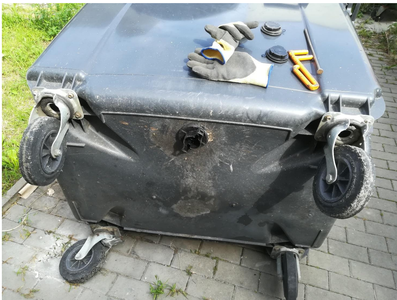
Obrázek č. 1: Správné osazení zátky na otvor ve dně kontejneru na komunální odpad zvládne pouze zkušený pracovník, foto: KHS.
